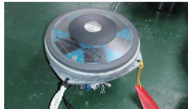
漁具の流出防止のためFADsおよび魚探ブイに取り付けるソナー衛星ブイ
